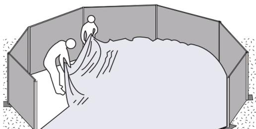
7. Positionnez la soudure extérieure (celle du fond et de la partie verticale) à égale distance de la structure métallique (le fond du liner ayant une surface plus petite que celle de la piscine), La soudure de la partie verticale du liner doit être parallèle à un bord vertical d'un panneau métallique.
