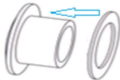
3. Placer entre le liner et la paroi l'autre joint et faites passer le passe paroi par cet orifice, de fait votre liner est pris entre les deux joints.
