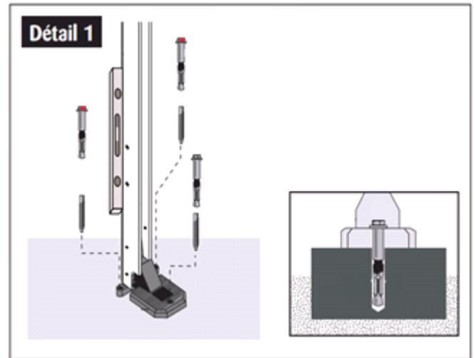
b) Placez les chevilles dans les trous sans les serrer en respectant l'emplacement des chevilles dynamométriques.
