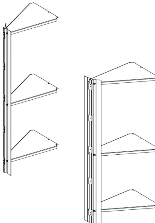
Assembler les montants bois composite par glissement dans les montants métal puis fixer avec les vis tôle 3.9 x 9.5mm.
