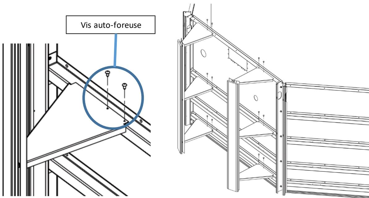
Installer les support de montant composite sur les poteaux du Skimmer Dress à l'aide des vis 3.9 x 9.5mm
