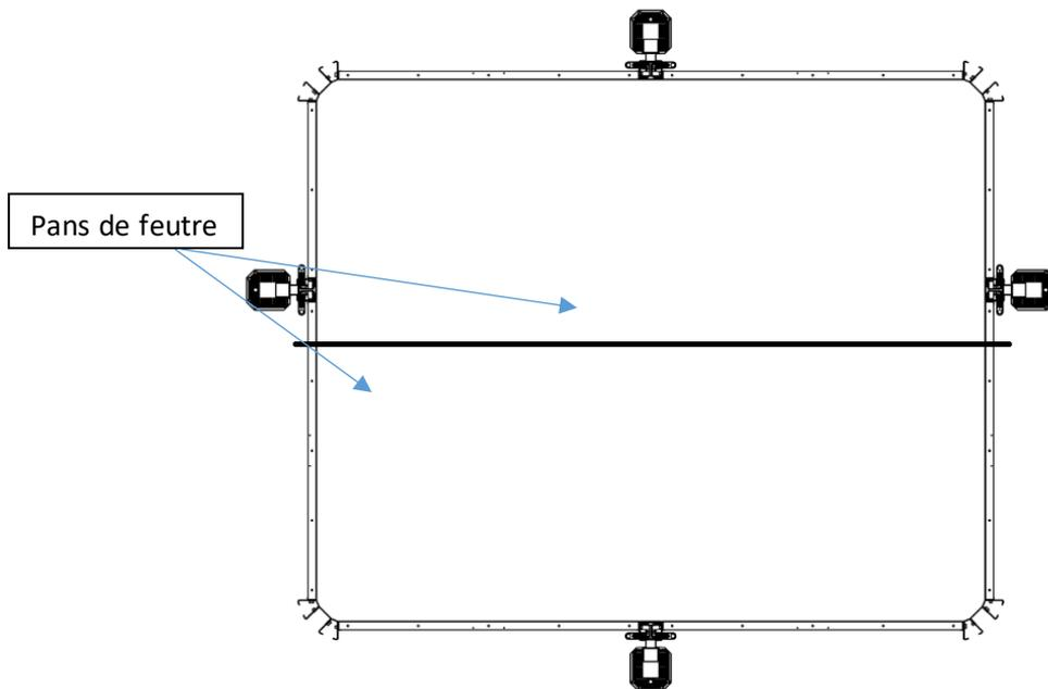
Solidariser les pans de feutre avec du scotch (non fournis), d'abords entre eux puis sur les panneaux, afin qu'ils ne bougent pas pendant l'installation du liner.
