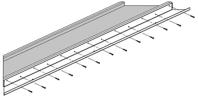
Fixez les charnières au support margelle à l'aide des vis, rondelles et écrous
