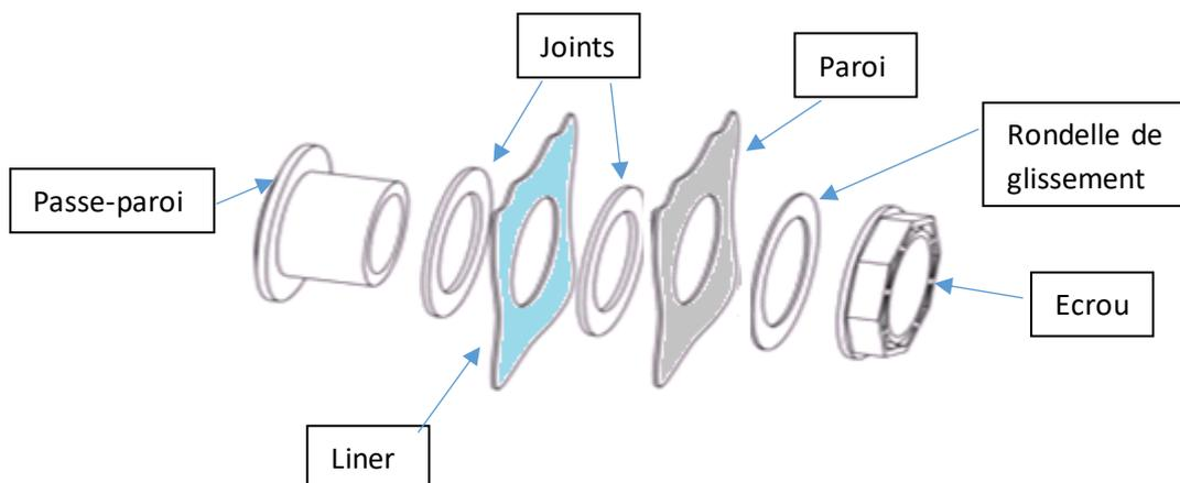
Avec un décapant, nettoyer les éléments PVC. Pour le collage, mettre la colle bleue sur chaque élément et assembler. Attention la colle à une prise très rapide, prenez soin d'avoir tous les éléments à portée de main, et éventuellement faire un montage à blanc pour éviter les erreurs.
