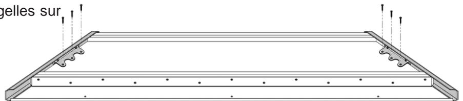
Nota : Il est parfois nécessaire de tapoter la pièce inox avec un maillet caoutchouc afin de bien l'emboîter sur la margelle
