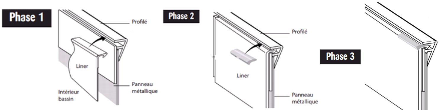
Vérifiez que la tension est uniforme sur la périphérie et qu'il n'y a pas de plis diagonaux dans le fond. A ce stade, ce sont ceux-là qu'il faut surtout éviter, au besoin repositionnez. Tendre le fond avec le talon en le tirant du centre vers l'extérieur.
