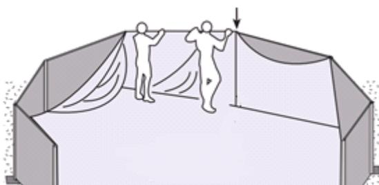
8. Accrocher le liner au profilé, puis mettre le jonc de blocage en suivant les phases suivantes
